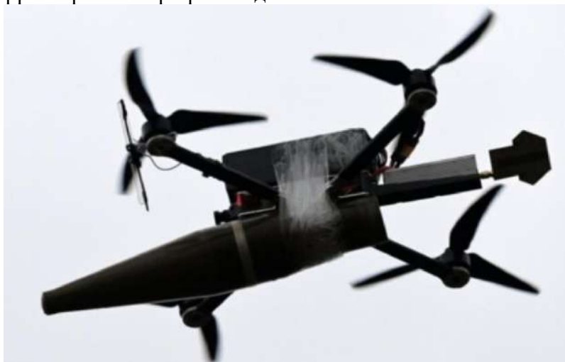
Рисунок 3- Квадрокоптер, оснащённый боеприпасом от РПГ-7.
