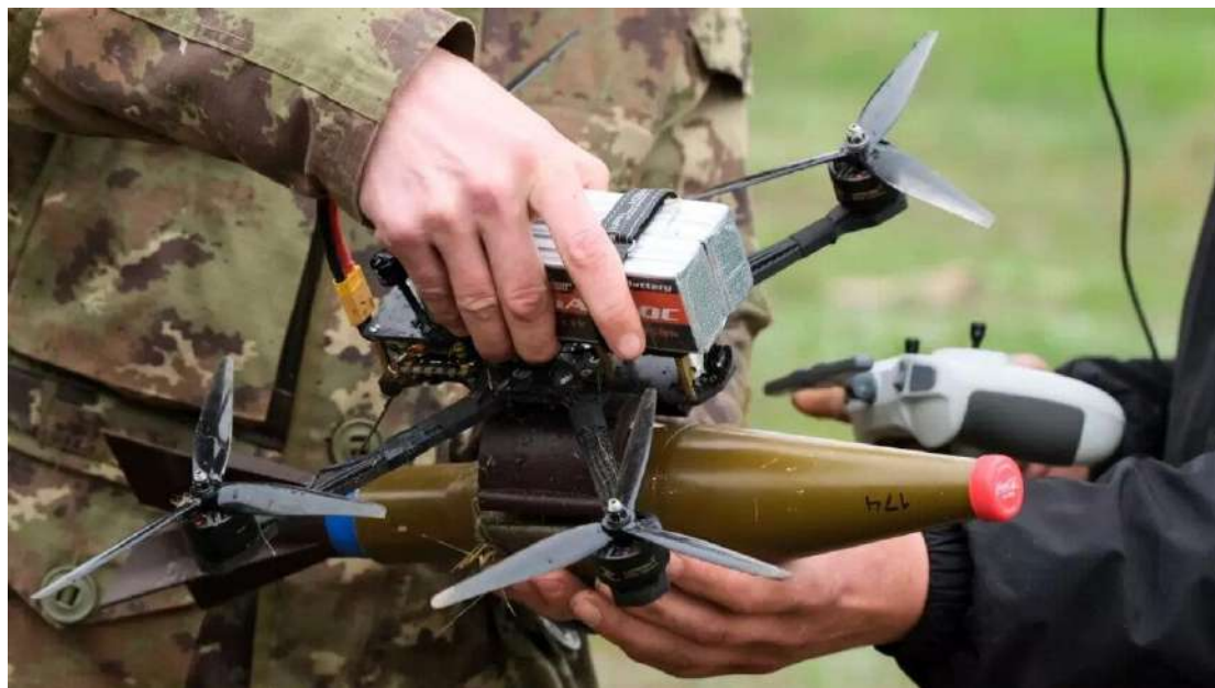
Рисунок 4- FPV-дрон "Упырь" с гранатой от РПГ-7.
