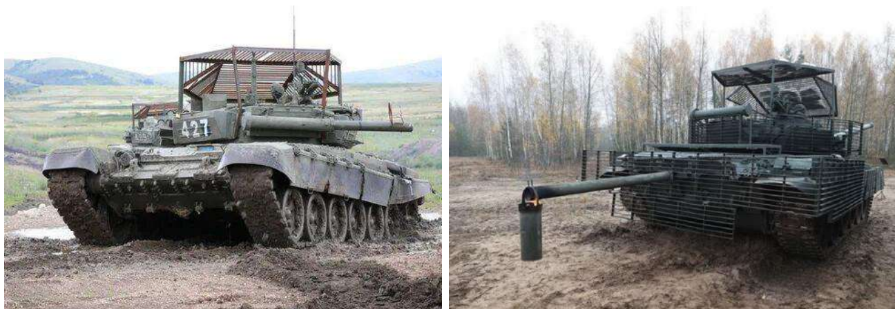
Рисунок 6- Самодельные меры защиты танка от БПЛА
